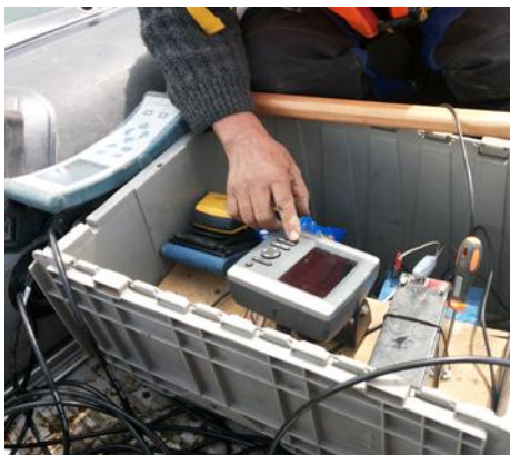
Figura N°2: Ecosonda MAP421 S Garmin en terreno.
